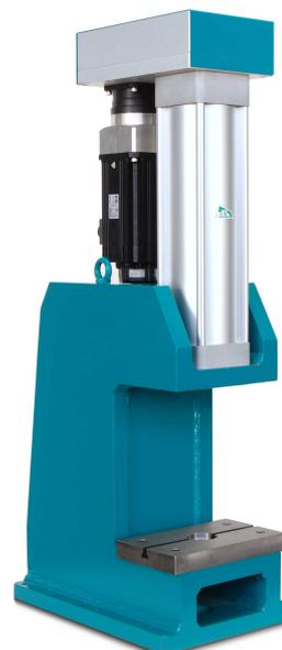
Struttura saldata a "C"
