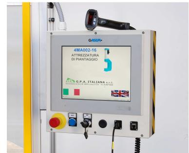
**Pannello di controllo** Servo Pressa CP 50 kN per settore automotive con sistema di lettura codice a barre dei pezzi
